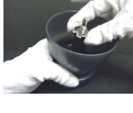
シャフト部分の上から粗さ調節ナットを通し、シャフト部分を摘んだ状態のまま粗さ調節ナットを時計回りに回し切り、完全に締めます。
