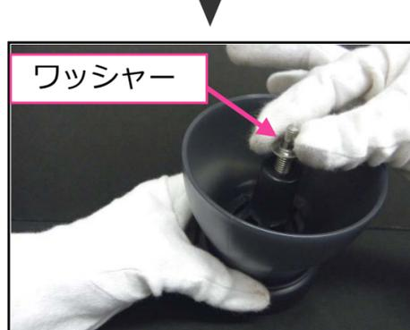
③粗さ調節ナットを完全に締めた状態から粗挽きになる方向（反時計回り）に1メモリずつ回し、その回したメモリの回数により粗さを調節します。
