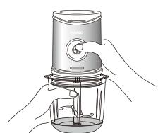
5. カッターが停止したら、プロセッサー碗から本体を取り外します。プロセッサー碗用フタから出ているカッターユニットのシャフトを指で押さえながら、フタを取り外します。その後、カッターユニットを取り外します。
